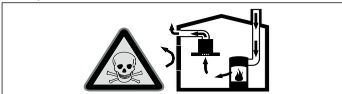
Locurile de gătit influențabile de aerul camerei (de ex. aparate de încălzit cu gaz, ulei, lemn sau cărbune, încălzitoare permanente, preparatoare de apă caldă) absorb aerul de ardere din spațiul în care sunt instalate și evacuează gazele arse în afară printr-o instalație de evacuare a gazelor (de ex. coș de fum).
